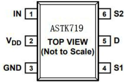
图 1 ASTK719 管脚定义图(俯视图)
